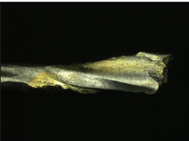
Eine fehlerhaft durchgeführte Lötstelle bei der Litzenherstellung hat zu diesem vorzeitigen Drahtbruch geführt. Digitalmikroskopische Aufnahme mit Farbinformationen.
