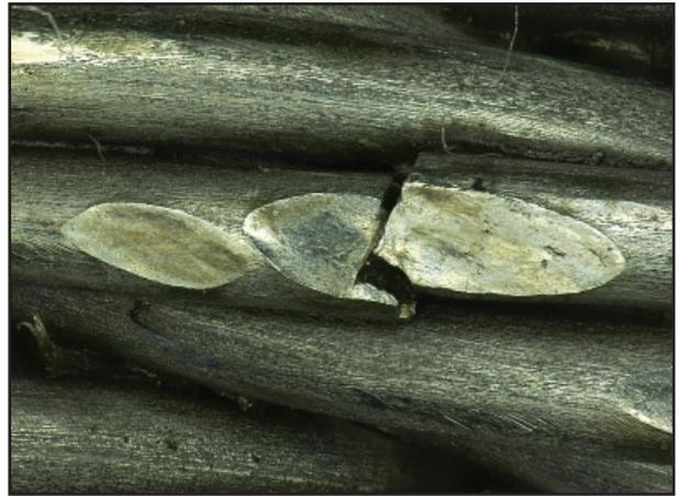
Drahtbrüche auf der Stahleinlage an der Berührungsstelle mit den Außenlitzen. Diese Arbeit wurde für CERN, Genf, durchgeführt.
