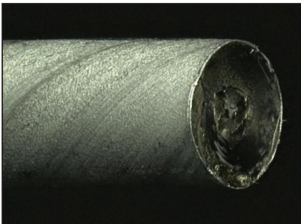
Dieser Draht ist in einem Torsionsversuch gebrochen. Die glänzende Bruchfläche liegt genau senkrecht zur Drahtachse.
