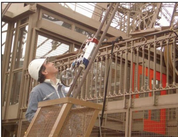
Jean- Marc Teissier inspiziert ein Aufzugseil auf dem Eiffelturm in Paris mit Hilfe eines magnetinduktiven Prüfgeräts.
