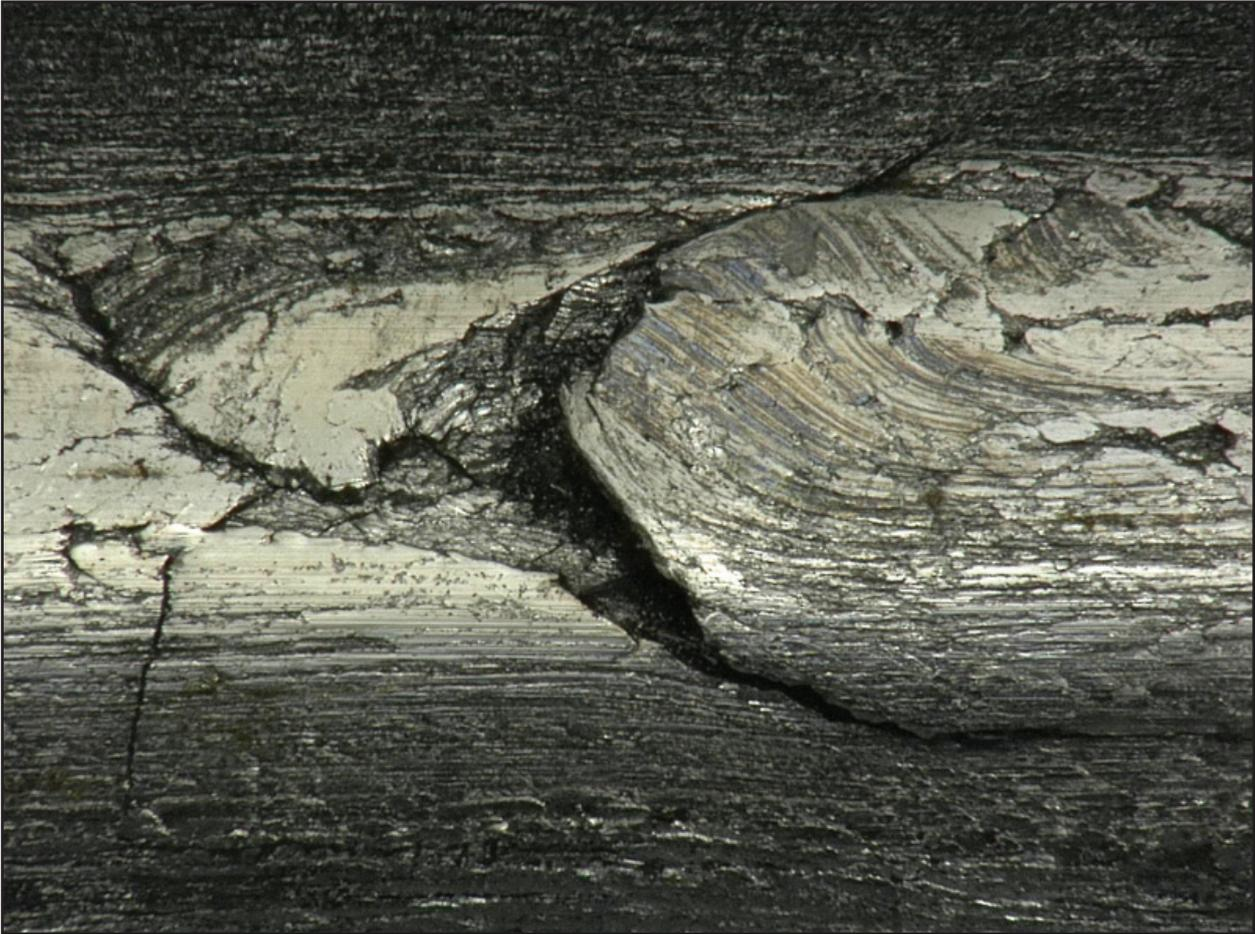
Dieser Seildraht hat einen Oberflächenfehler, der als Krähenfuß bezeichnet wird. Dieser Fehler wurde während des Drahtzugs erzeugt. Wenn ein solcher Schaden nicht durch die Eingangskontrolle des Drahtseilherstellers erkannt wird, kann er im Drahtseil vorzeitige Drahtbrüche erzeugen. Multifokusaufnahme im Digitalmikroskop.
