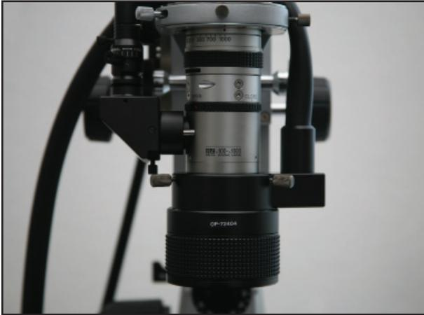
Wir untersuchen Drähte und Litzen mit zwei Digitalmikroskopen mit Multifokuseinrichtung und Vergrößerungen von 5x bis 1000 x.
