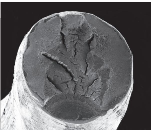
Dieser Draht wurde zunächst durch einen Ermüdungsriß geschwächt (unterer Bereich) und brach dann durch eine Überlast. Rasterelektronenmikroskopisches Bild.
