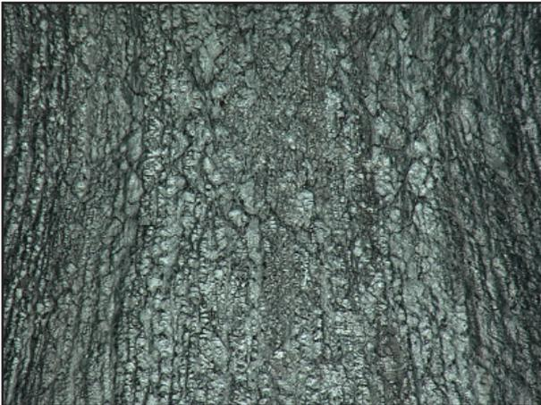
Drahtoberfläche eines Überlastbruchs. Die ursprünglich glatte Oberfläche hat sich infolge der Brucheinschnürung gefaltet. Labortest.
