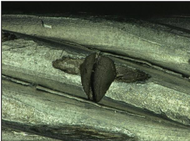
Ein "doppelter" Drahtbruch infolge einer Torsionsschwellbeanspruchung. Multifokusaufnahme im Digitalmikroskop.
