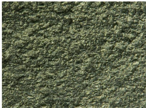
Oberfläche eines Ermüdungsbruchs (Digitalmikroskop, Vergrößerung 900 x). Derartige Vergrößerungen sind mit konventionellen Mikroskopen nicht erreichbar.
