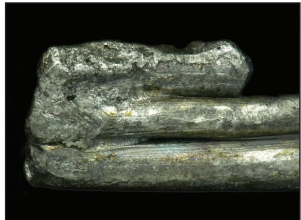
Fünf Menschen wurden getötet, als im Fernen Osten ein Hubseil riß. Das Seil war zuvor durch einen Blitzschlag beschädigt worden. Drahtdurchmesser 0,3 mm.
