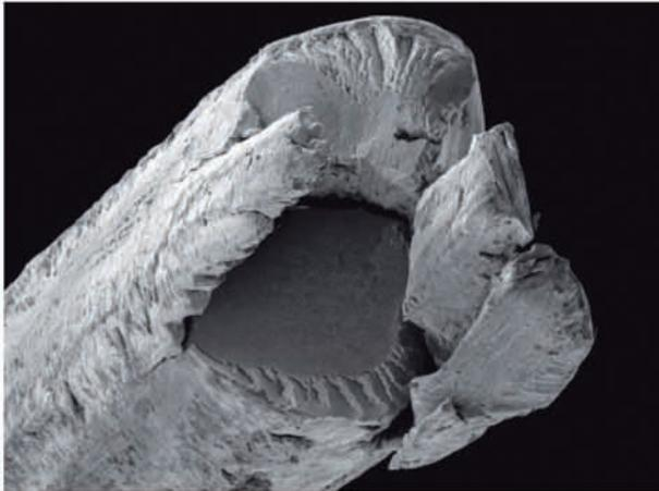
Mechanische Beschädigung eines Drahtes (gleiches Seil wie oben). Das Zentrum des Drahtes ist als Scherbruch gebrochen.
