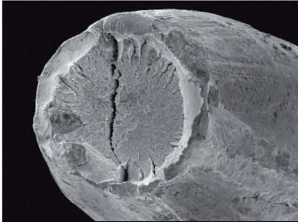
Überlastbruch eines Drahtes (ein typischer Zugkegel). Das Seil war aus der Seilscheibe herausgesprungen. Kunde: Shell
