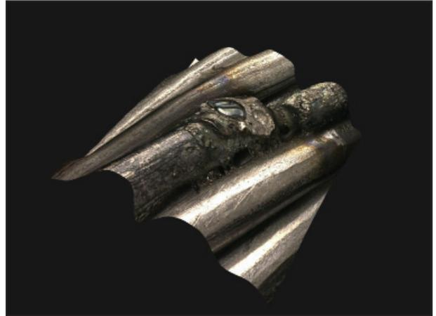
Beschädigung einer Litze durch einen Blitzschlag. Dieses 3D-Photo haben wir für die NASA (Kennedy Space Center) hergestellt.
