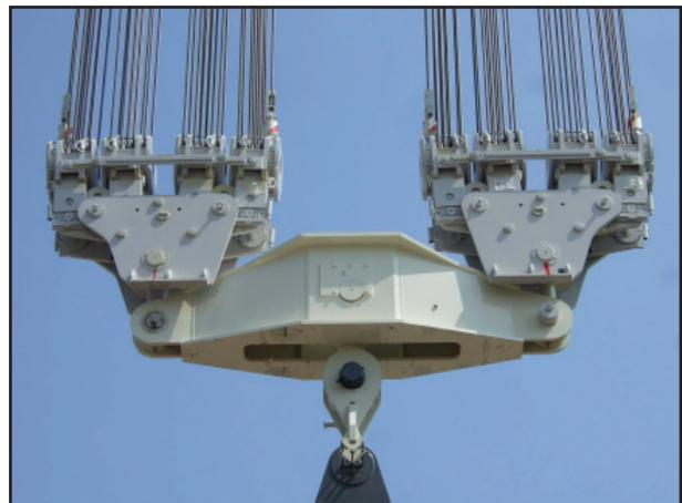
... und auch das komplexe Einschersystem des Terex Demag CC8200 Twin, des größten Landkrans der Erde.
