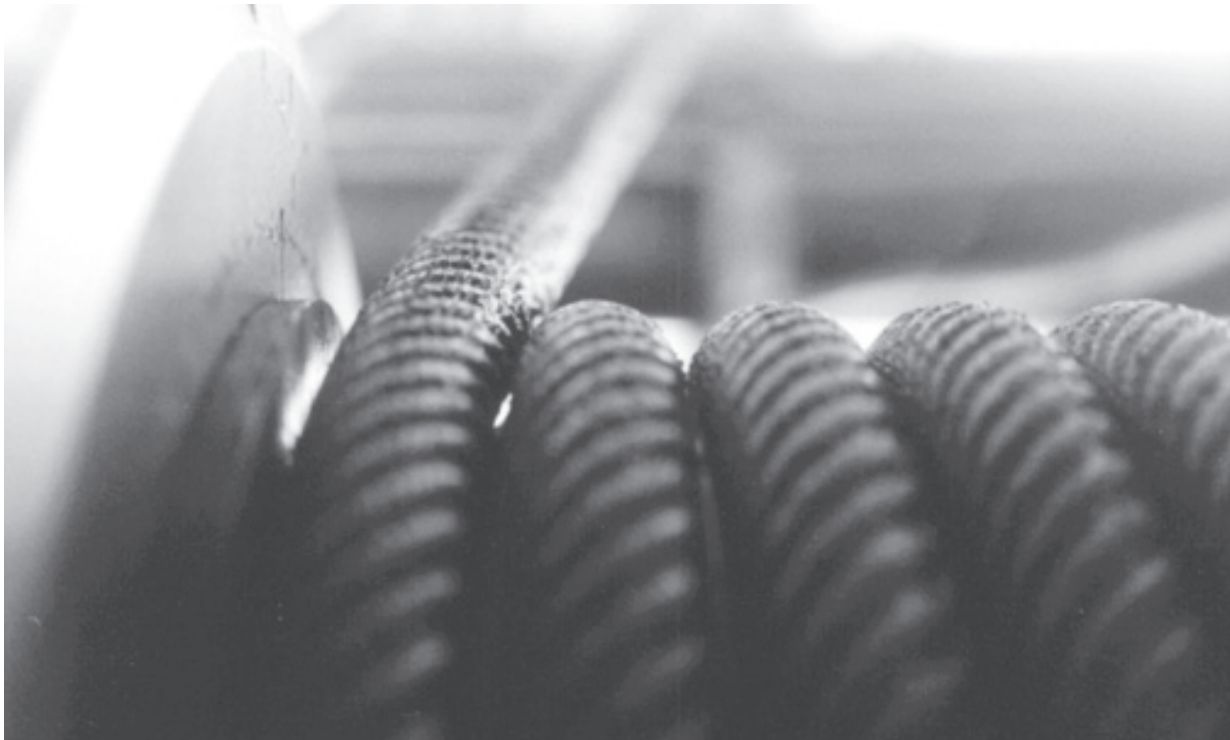
Rys. 44: Pod wpływem kąta odchylenia, lina stalowa ściągana jest na sąsiedni zwój. Druty zewnętrzne ulegają uszkodzeniu w miejscu styku.
