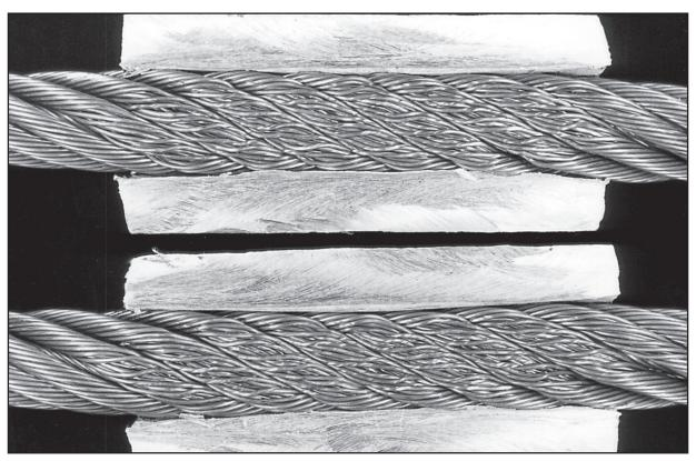
Fig. 45: Coupe d'un manchon - Zones de contact des deux brins d'un câble croisé
