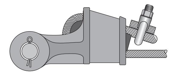
Fig. 20: Fixation du brin " mort " avec un autre morceau de câble
