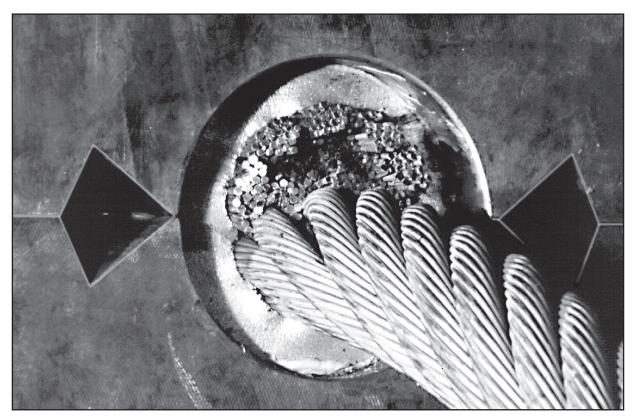
Fig. 43: Sertissage du manchon aluminium
