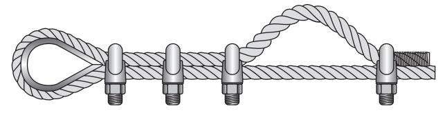
Fig. 9: Le brin "mort" forme une boucle – le câble n'a pas glissé
