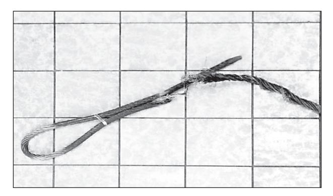
Fig. 18: Rupture du brin tendu au niveau du point de liaison
