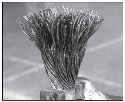
Fig. 68: Tête de câble mise en forme de bouquet par détoronnage des torons
