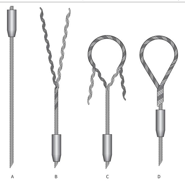
Fig. 53: Fabrication d'un Œil Flamand
