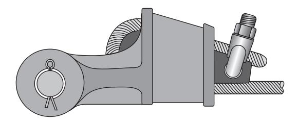
Fig. 25: Fixation du brin "mort" sur le coin
