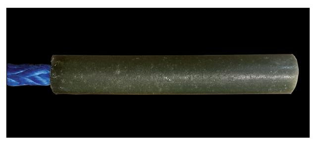
Fig. 90: Manchon coulé en résine réalisé sur un câble en fibres
