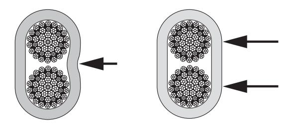
Fig. 41: Mauvaise préparation du manchon
