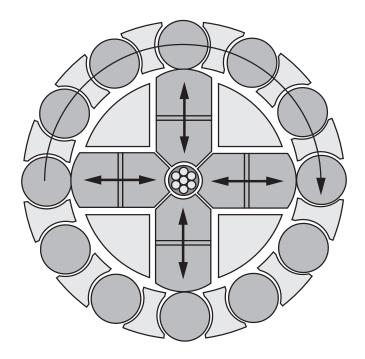
Fig. 58: Coupe schématique d'une presse rotative pour le sertissage des douilles
