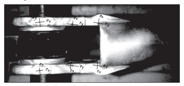
Fig. 65: Analyse par photo élasticité d'un culot ouvert
