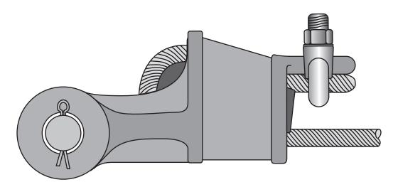
Fig. 24: Fixation du brin "mort" sur le corps du culot
