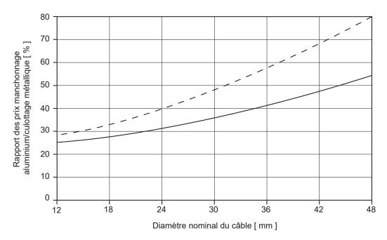
Fig. 92: Rapport entre le prix d'un manchonnage aluminium et celui d'un culottage - avec et sans prise en compte de l'augmentation du du câble pour le manchonnage.
