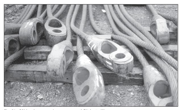
Fig. 61: Câbles de suspension pour grues à flèche treillis
