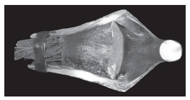
Fig. 78: Coupe d'un culot en forme de poire montrant l'endommagement du câble.
