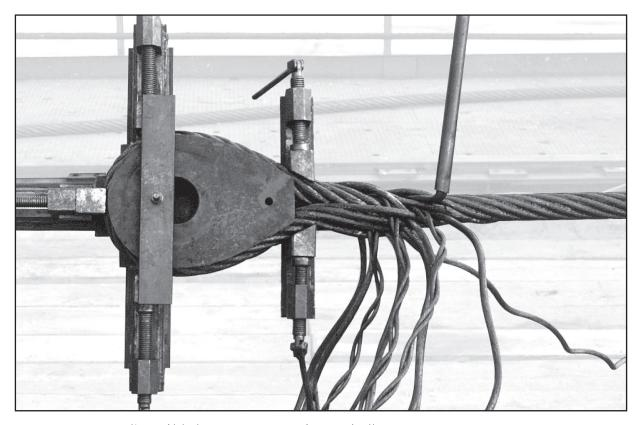
Fig. 32: Epissure d'un câble huit torons avec âme métallique
