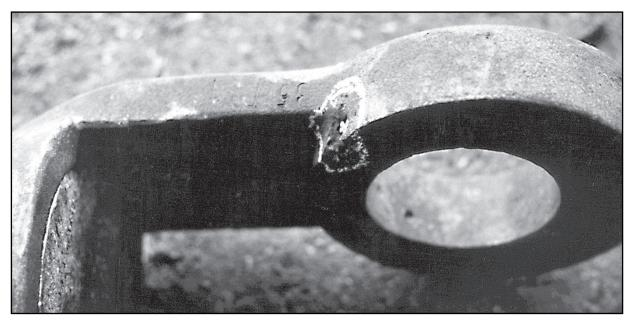
Fig. 67: Défaut de coulée sur un des bras de la chape d'un culot à chape femelle
