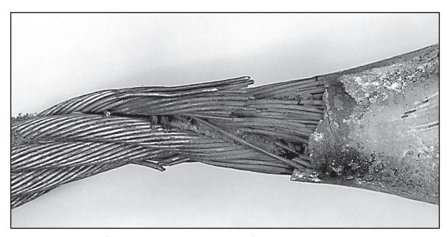
Fig. 81: Corrosion et fils cassés à la sortie du culot en forme de poire
