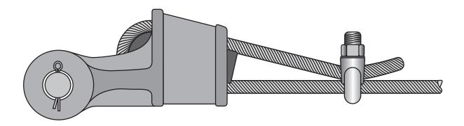
Fig. 17: Montage incorrect avec liaison du brin "mort" sur le brin tendu
