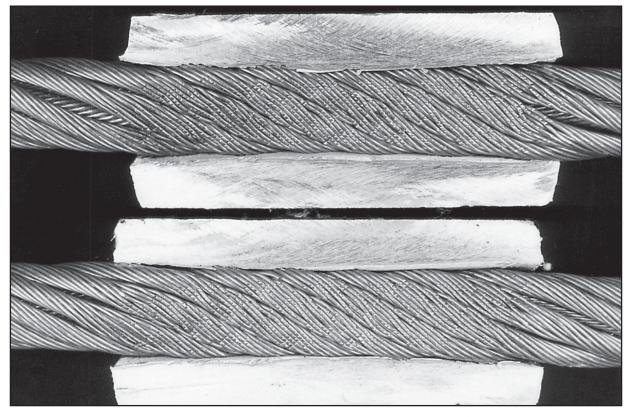
Fig. 46: Coupe d'un manchon - Zones de contact des deux brins d'un câble Lang
