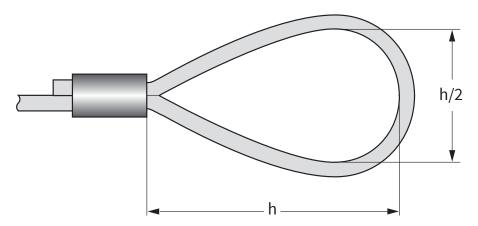
Fig. 40: Dimensions de la boucle
