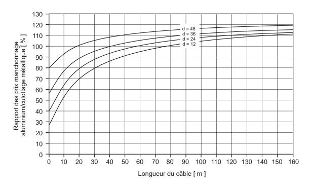
Fig. 93: Rapport entre le prix d'un manchonnage aluminium et celui d'un culottage - avec prise en compte de l'augmentation du diamètre et du prix du câble pour le manchonnage
