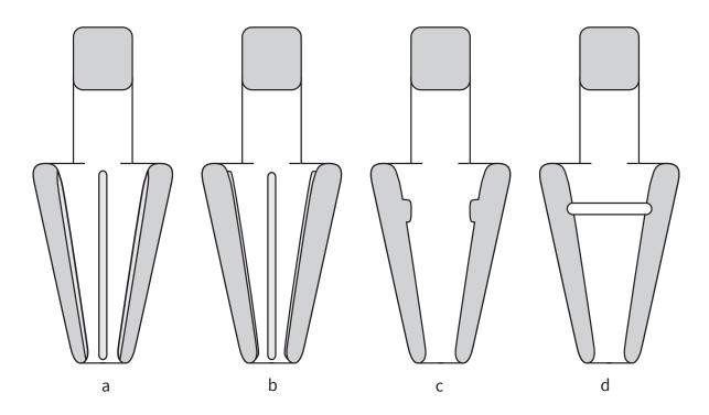
Fig. 66: Types de systèmes antirotation
