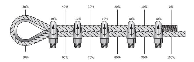
Fig. 5: La répartition des efforts au sein d'une terminaison par serre-câbles
