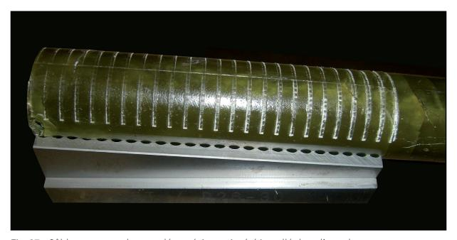
Fig. 87: Câble avec manchon coulé en résine qui a été installé dans l'attache
