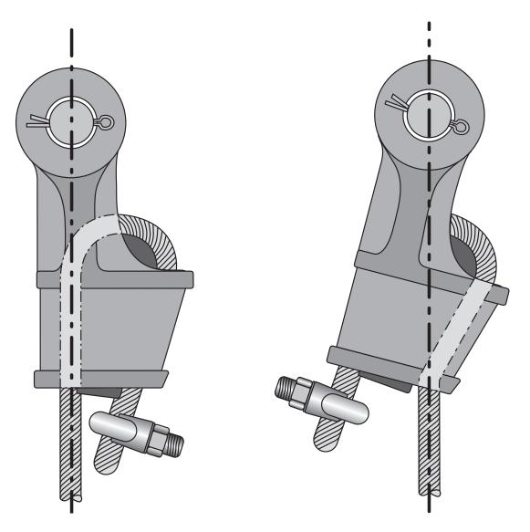
Fig. 15: Montage correct de la boîte à coin
