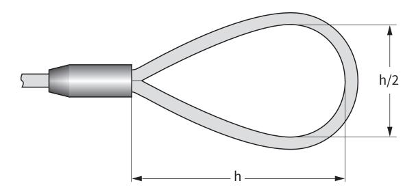
Fig. 54: Dimensions de la boucle
