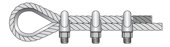
Fig. 2: Terminaison utilisant des serre-câbles
