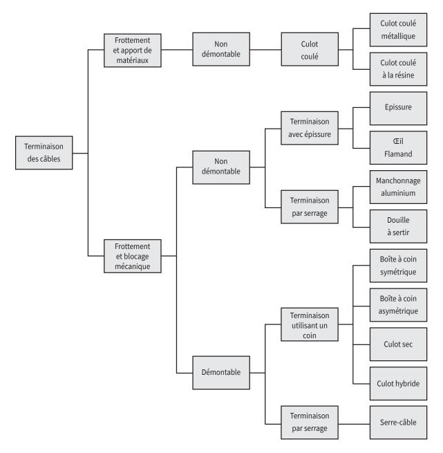
Fig. 1: La classification des attaches terminales
