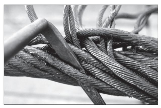
Fig. 33: Epissure d'un câble huit torons avec âme métallique (détail)
