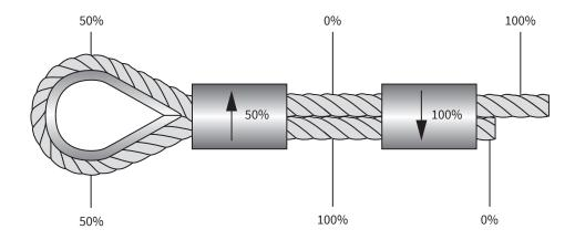
Fig. 48: Transfert des forces dans un manchonnage réalisé avec deux manchons
