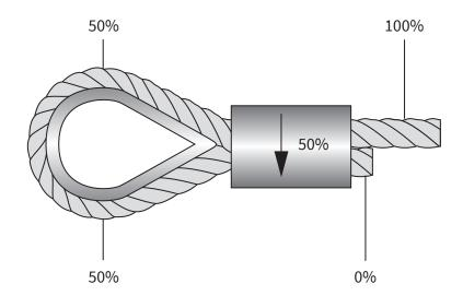
Fig. 47: Transfert des forces dans un manchonnage aluminium.
