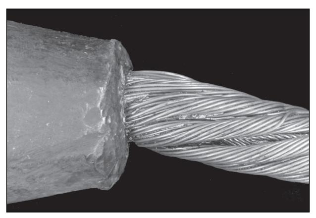
Fig. 71: Câble mal positionné avant la coulée
