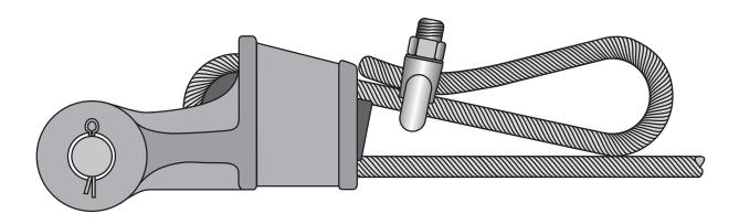
Fig. 21: Fixation recommandée du brin "mort"
