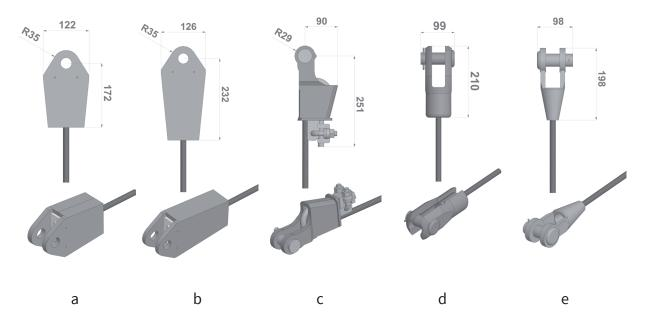
Fig. 83: Comparaison de différentes terminaisons: (a) Culot hybride pour câble acier, (b) Culot hybride pour câble fibre, (c) boite à coin asymétrique, (d) douille avec embout, (e) douille conique. (les dimensions correspondent à un câble de 16 mm)
