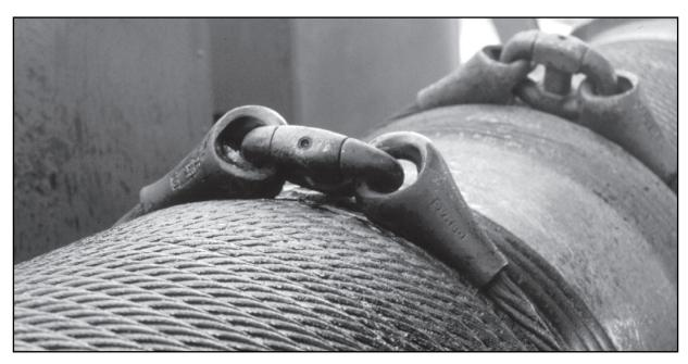
Fig. 77: Culot en forme de poire avec maillon, enroulé sur un tambour.
