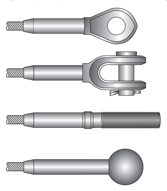
Fig. 56: Différents types de douille à sertir
