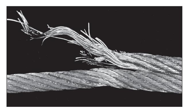
Fig. 19: Rupture du brin tendu au niveau du point de liaison (détail)
