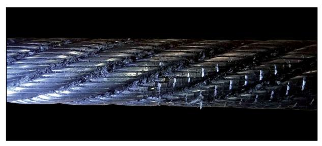
Fig. 86: Câble acier qui a été installé dans l'attache sans manchon coulé
