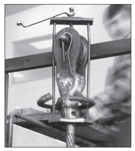
Fig. 73: Préchauffage du corps du culot
