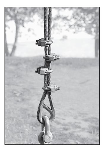
Fig. 8: Terminaison réalisée avec des serre-câbles mal montés
