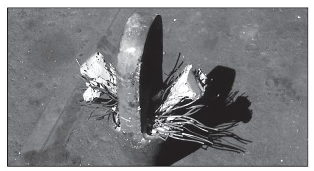
Fig. 82: Culot à la résine poussé mécaniquement hors du corps du culot
