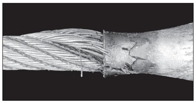
Fig. 79: Coupe du cône coulé d'un culot en forme de poire montrant l'endommagement du câble.
