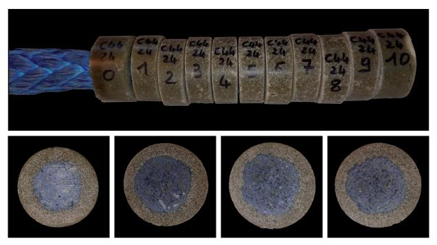
Fig. 91: Répartition des fibres à l'intérieur du manchon coulé en différentes sections
