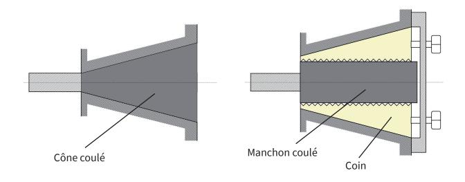
Fig. 84: Culot classique Fig. 85: Culot hybride
