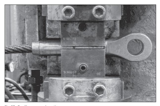
Fig. 57: Douille en cours de sertissage
