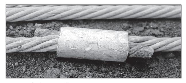
Fig. 49: Type de raboutage interdit
