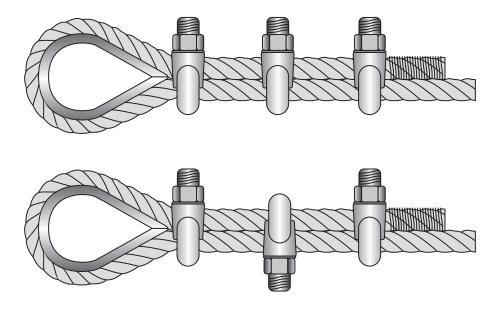
Fig. 6: Terminaison réalisée avec des serre-câbles mal montés
