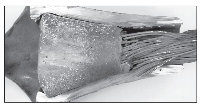
Fig. 80: Corrosion et fils cassés à la sortie du culot en forme de poire
