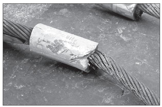
Fig. 50: Endommagement d'un manchon aluminium
