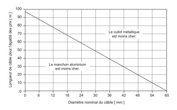
Fig. 94: Longueur de câble nécessaire pour obtenir l'égalité des prix. Au-dessus de la longueur de câble de suspension indiquée, la terminaison avec culot est plus économique que celle par manchonnage.
