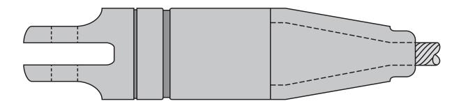
Fig. 75: Culot avec émerillon intégré.
