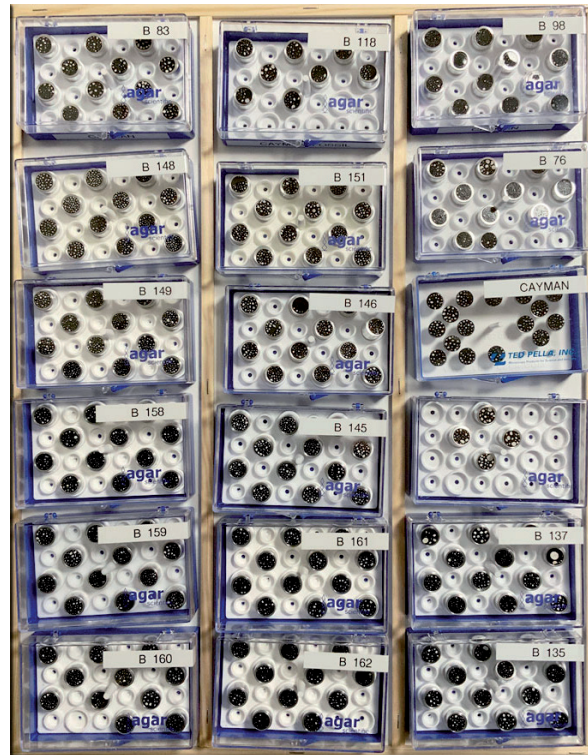
Abb. 1: Probenhalter mit montierten Foraminiferen
