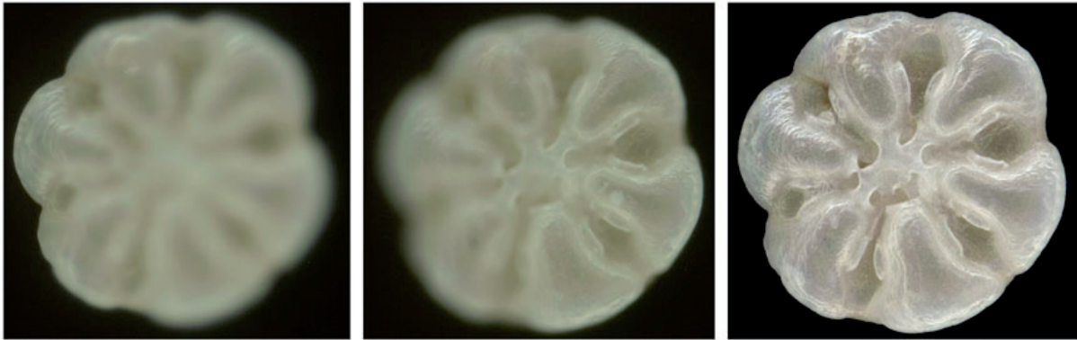
Abb. 17: Links steht das erste Bild (links) einer Serie von 27 Bildern. Das Bild in der Mitte zeigt das letzte Bild Foto der Serie. Das Bild rechts zeigt das Ergebnis des Stackings, der Zusammensetzung der Einzelbilder zu einem einzigen scharfen Bild.
